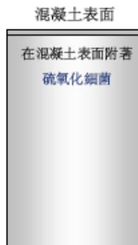
→ 混凝土表面的 pH 低下
