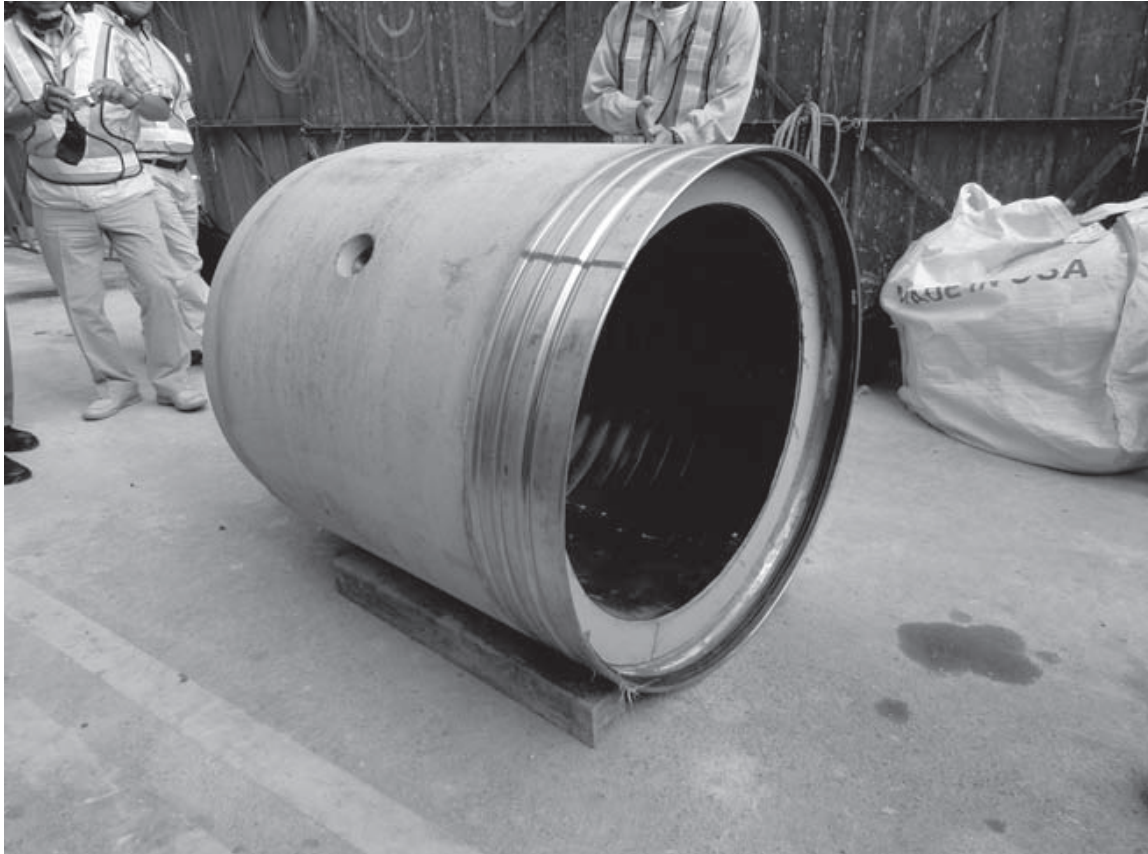
照片-10 使用之推進管( \phi 800\text{mm} 、管長 1000\text{mm} 、不銹鋼接頭)
