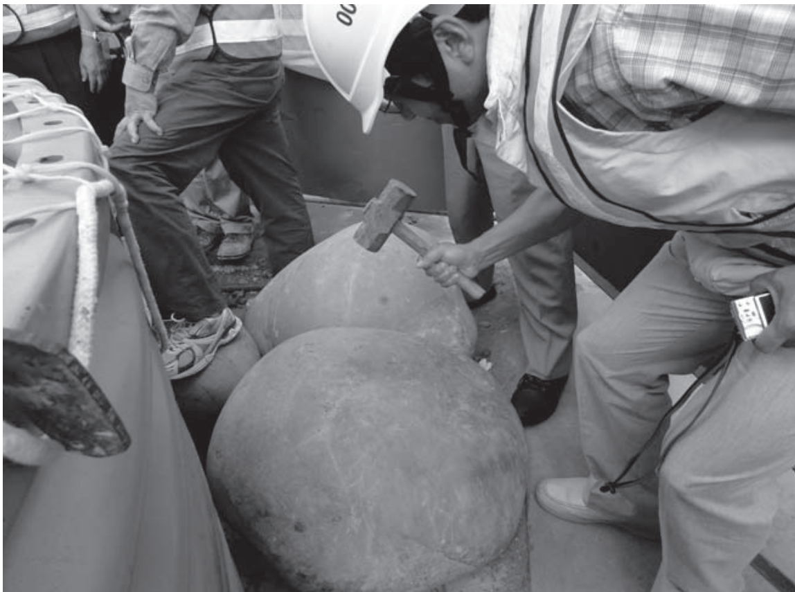
照片-9 卵石以鐵鎚敲擊發出堅硬金屬聲音
