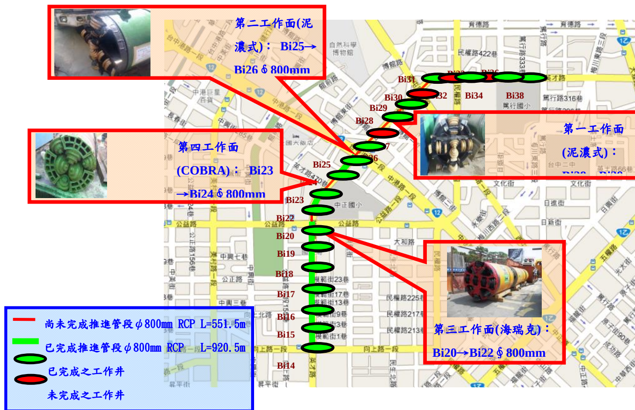
圖-2 英才路次幹管工程（一）計畫圖
