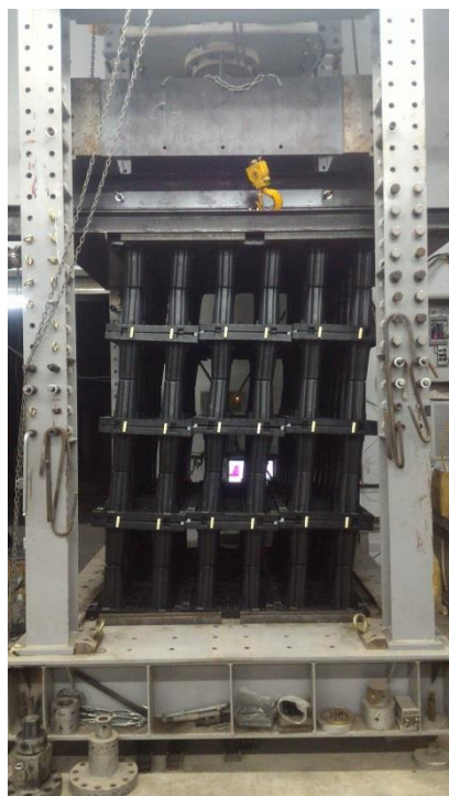
附照片 3-1 往復荷載抗剪試驗裝置概況
