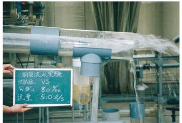
圖-11 試驗狀況 (VS 200-150 ; 5.0 l/s 80‰)
