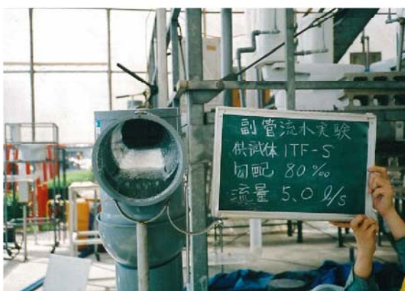
圖-12 試驗狀況 (ITF-S 200-150 ; 5.0 l/s 80‰)
