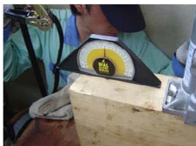
圖四：管線傾斜 11^\circ 不漏水試驗
