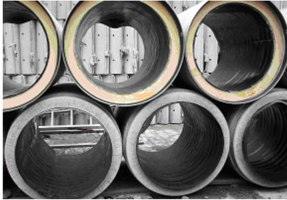
塑膠裡襯混凝土管圖示
