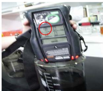
未加入除臭劑硫化氫之測定值為 160 ppm
